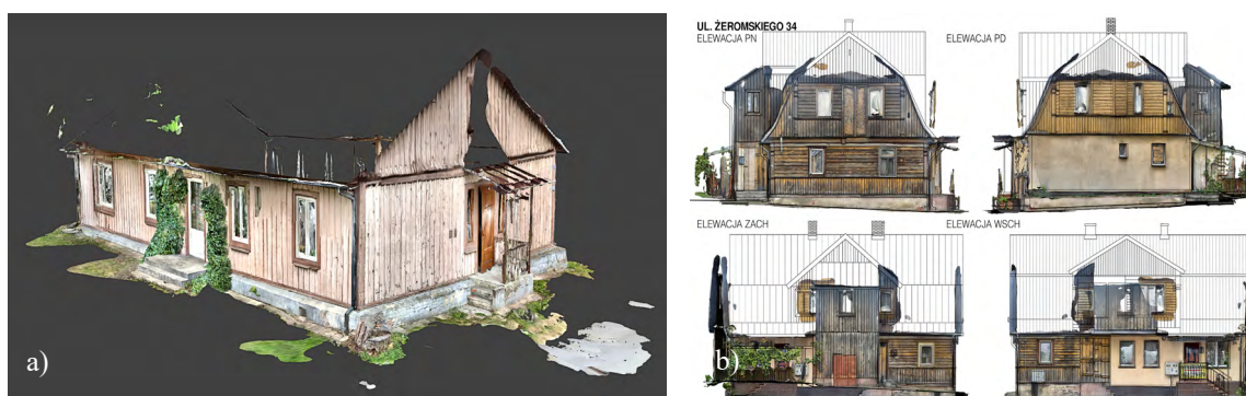
Il. 6. Wykorzystanie metody skanowania 3D w pracach inwentaryzacyjnych: a) Inwentaryzacja domu przy ul. Piłsudskiego; b) Inwentaryzacja domu przy ul. Żeromskiego. Oprac. M. Patriak, 2022.
